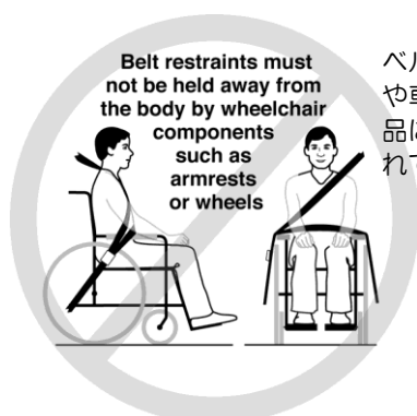
図3a - 骨盤ベルトの位置が不適切。アームサポートの外側から取り付けられている。
