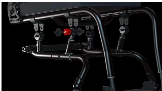
革新的な ISO テック は上下二重構造フレームのデザインで特殊なポリマー素材でフレームを繋ぐことで大幅に振動軽減を実現した海外で高く評価されているテクノロジーです。走行時の振動軽減は科学的に実証されています。
