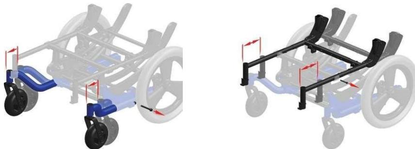
これほど簡単に調整できるチルト車いすはありません。2本のボルトを外すだけでシートフレームをスライドさせて車体を分解せずに重心位置の調整ができます。ほとんどの調整はユーザーが着座したままで調整が可能です。キャスターの前後位置調整も2本のボルトを外すだけです。
