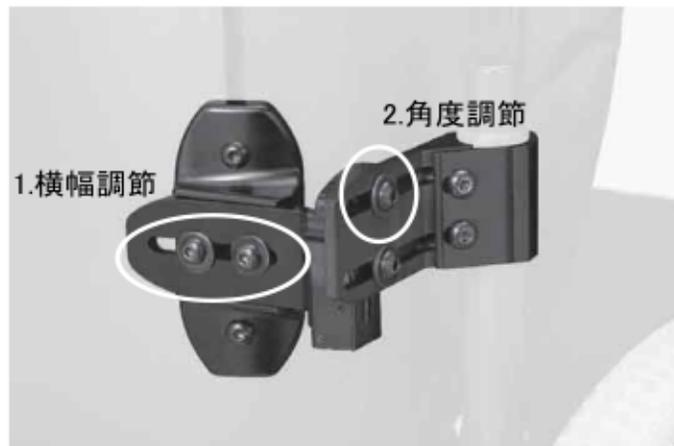
3. 左右のホルスターの角度は同じでしょうか。調節ネジを緩めてチェックして下さい。ケインブラケットの上側のネジで角度を調整しますが、このネジは3/4回転まわして角度を調節して下さい。
